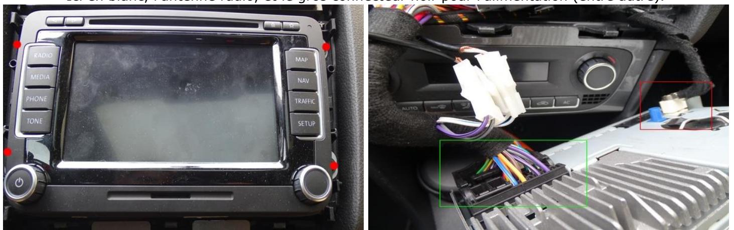
3) Déconnecter l'antenne et le connecteur d'alimentation. Pour l'antenne, Appuyer sur la petite partie en plastique, et pour l'alimentation, il faut faire levier avec la partie en rouge.
