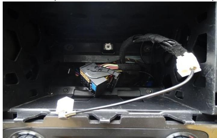
2) Connecter l'antenne et le connecteur d'alimentation au nouveau poste. Pas besoin de plus d'explication, c'est la même chose que pour le démontage mais à l'inverse.
